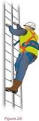
Figure V-3 : L'antichute mobile sur support d'assurance vertical
