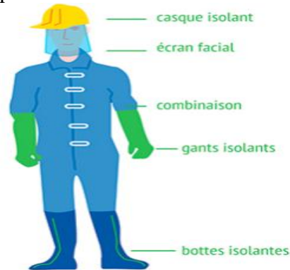
Figure III.8 : Equipements de protection individuelle pour les travaux sous basse tension
