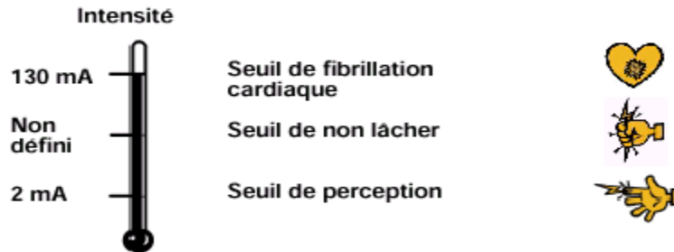
Figure II.12 : Seuils de danger du courant électrique continu
