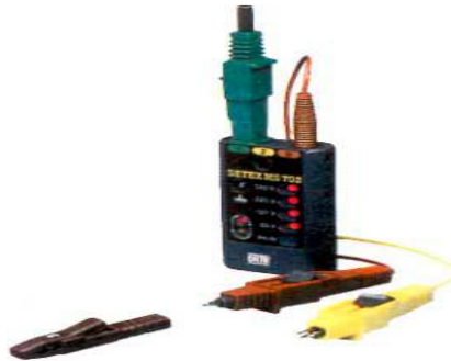
Figure III.13 : Vérificateur d'absence de tension en BT
