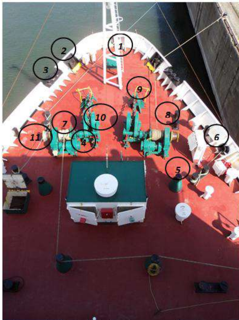
Figure2.2 : Équipements d'amarrage avant
