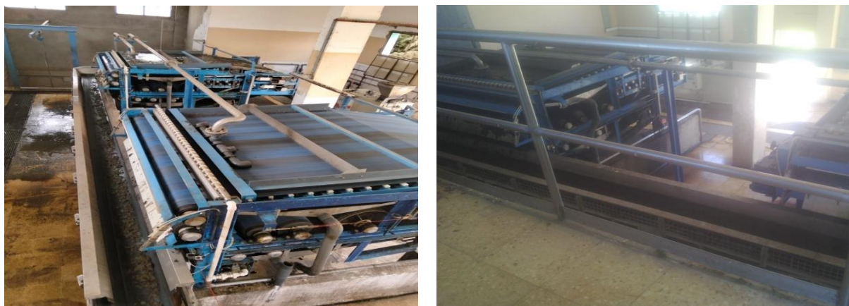
Figure III.18: Bande presseuse ( Keddar et Mankouri, 2021 ).
