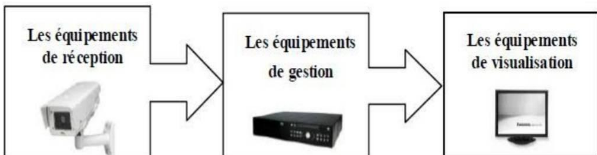
Figure 36: Fonctions d'une installation vidéo surveillance
