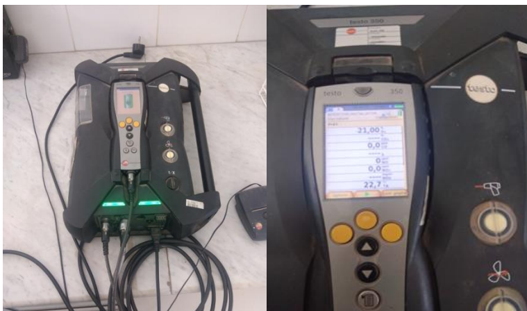
Figure 4: Analyseur polyvalent des gaz de combustion testo 350
