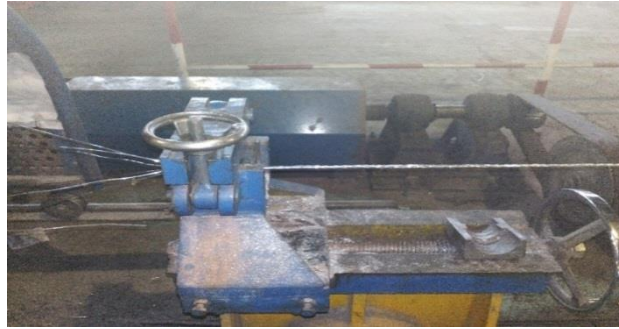
Figure III-6. Machine de câblage au niveau de la câblerie
