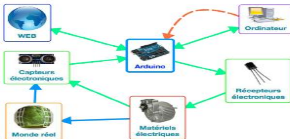
Figure 20: Architecture d'un système à base d'une carte Arduino
