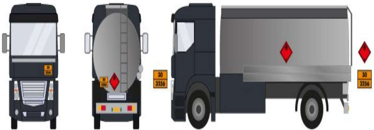
Figure II.7 : La position de la signalisation pour une citerne mono cuve et un type de produit.
