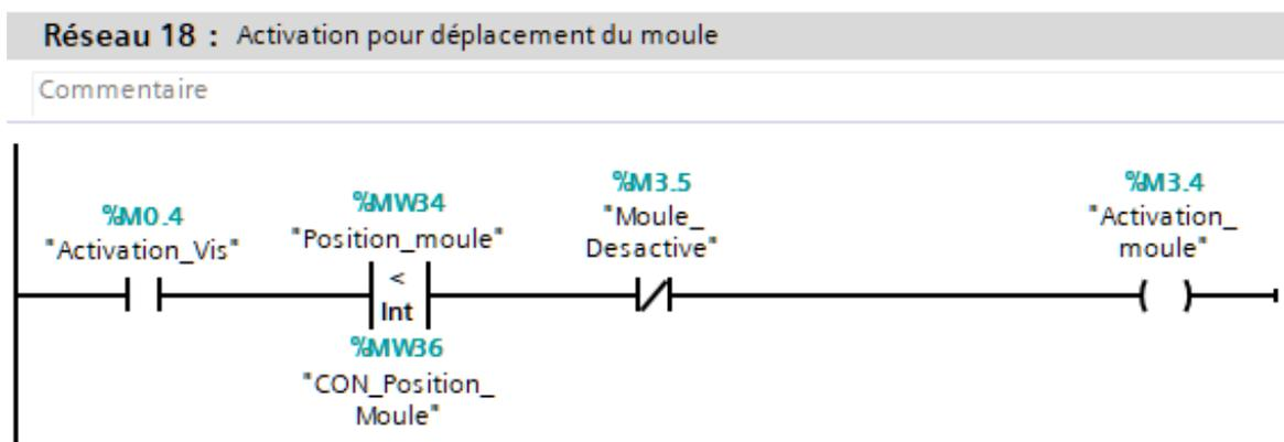
Figure III. 64 : Activation pour le déplacement du moule
