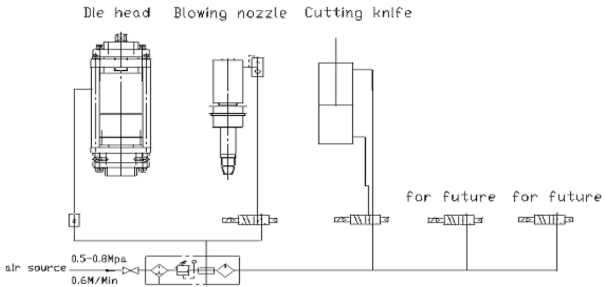
Figure II. 23 : Schéma technique du système pneumatique
