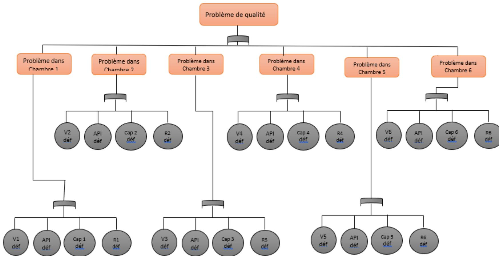
Figure III. 81 : Arbre de défaillance redoutée
