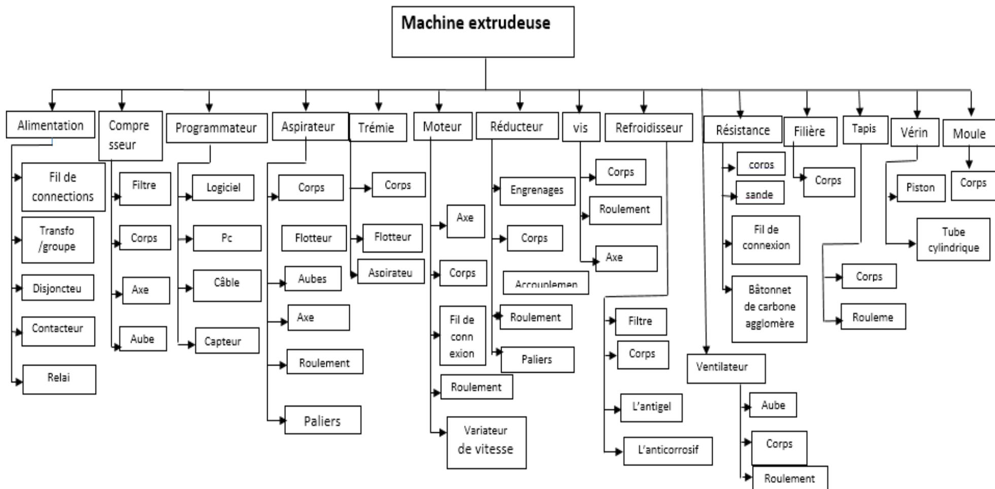
Figure III. 78 : Analyse structurelle de la machine Extrudeuse
