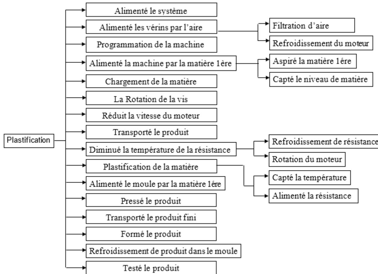
Figure III. 79 : Analyse fonctionnelle de la machine
