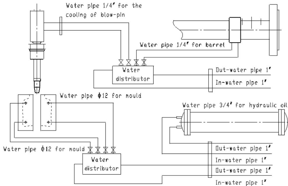
Figure II. 24 : Schéma technique du système de refroidissement
