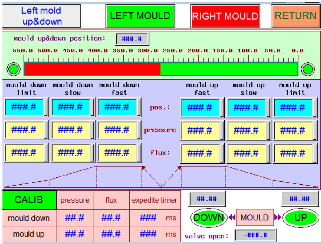
Figure II. 31 : Menu de modification des paramètres de pression
