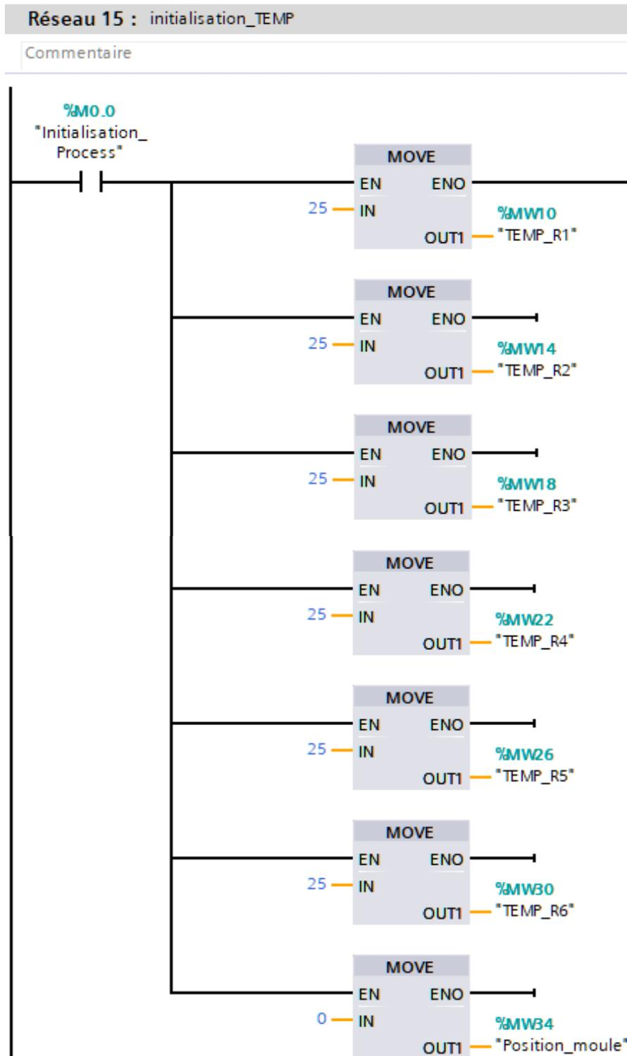
Figure III. 60 : Initialisation des grandeurs variables : température et position
