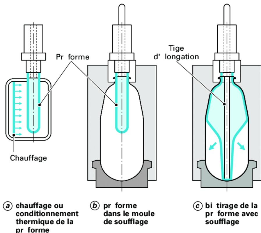
Figure I. 9 : Procédé de moulage par injection-soufflage [32]
