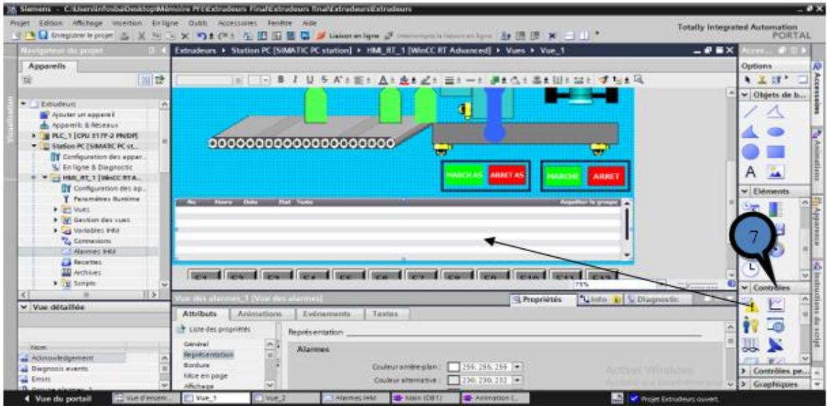
Figure20 : Configuration des alarmes
