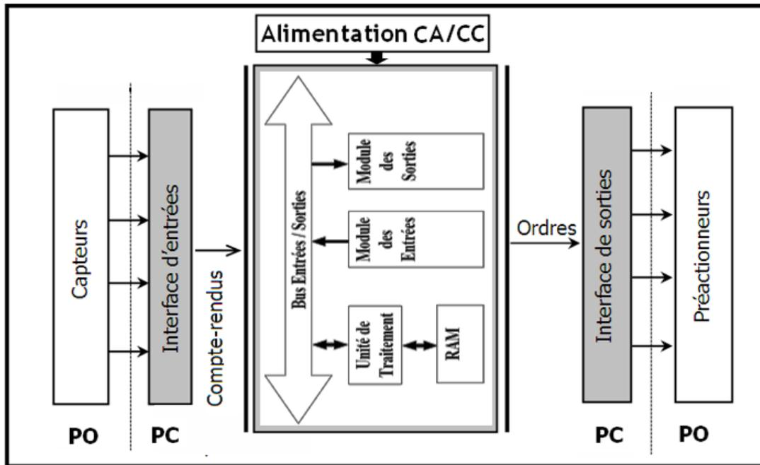
Figure II. 41 : Structure interne d'un automate programmable industriel (API)
