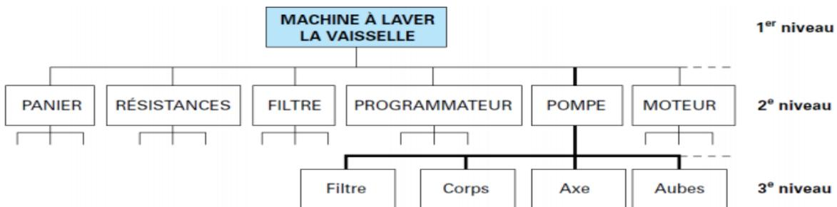
Figure I. 17 : Diagramme Analyse Structurale
