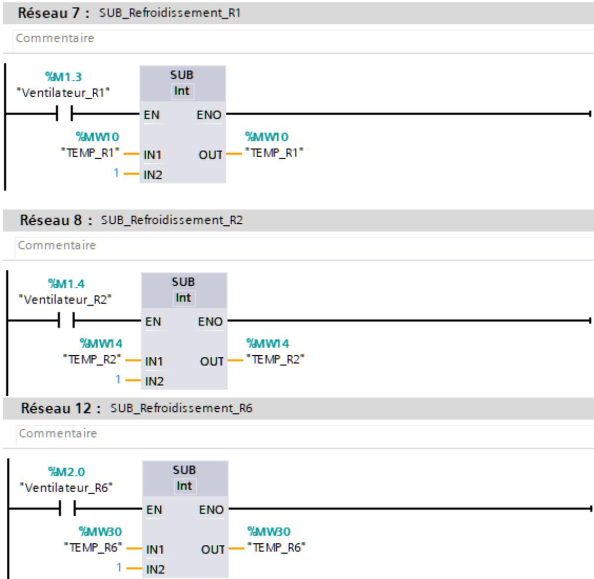
Figure III. 68 :Refroidissement de la résistance R1, R2 et R6
