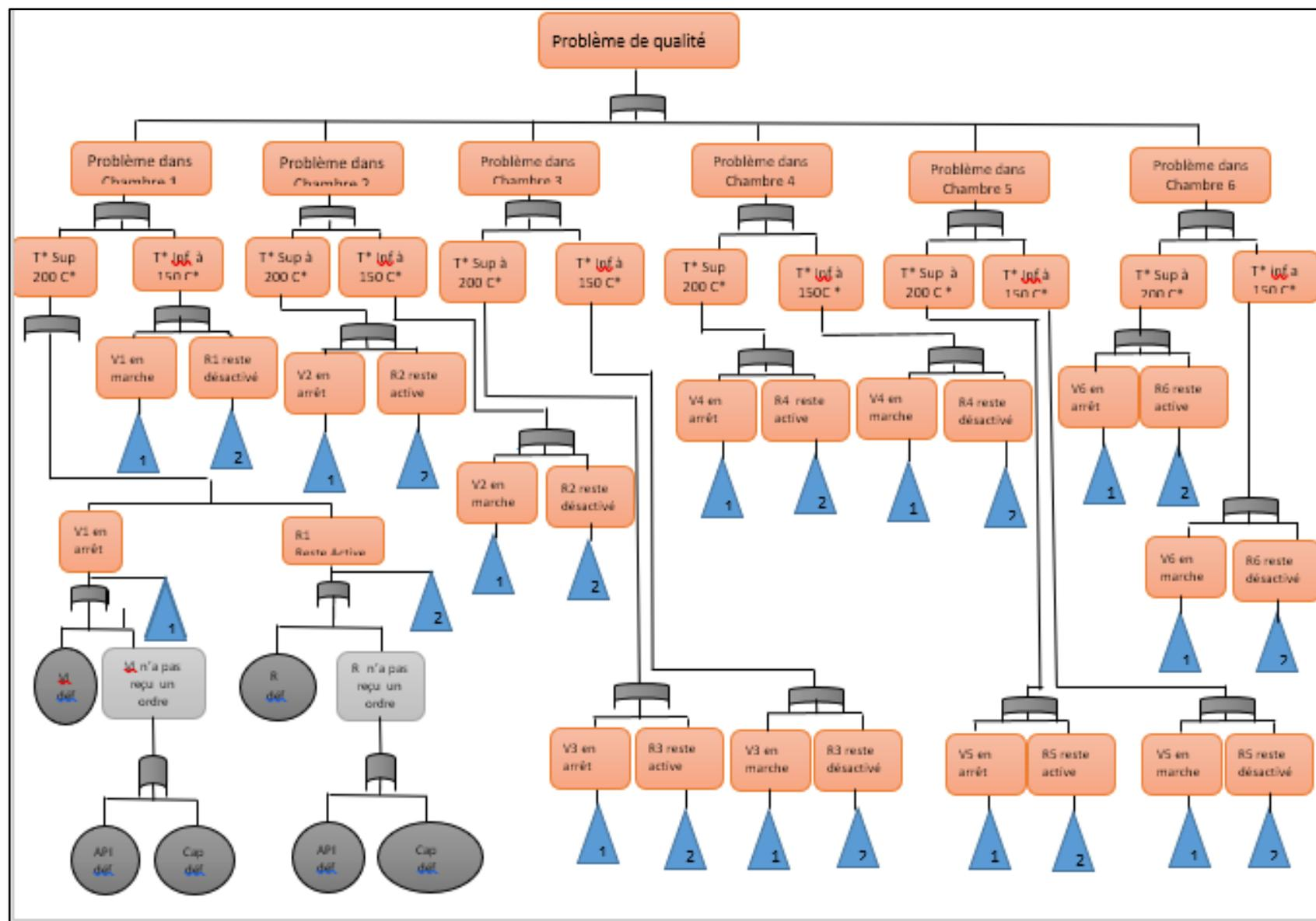
Figure III. 80 : Arbre de défaillance de la partie plastification
