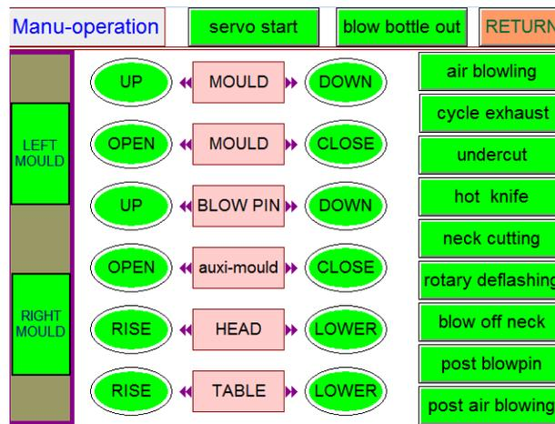
Figure II. 29 : Menu de fonctionnement manuel du moule
