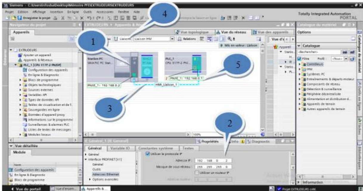
Figure 10 : Connexion entre la station PC et PLC
