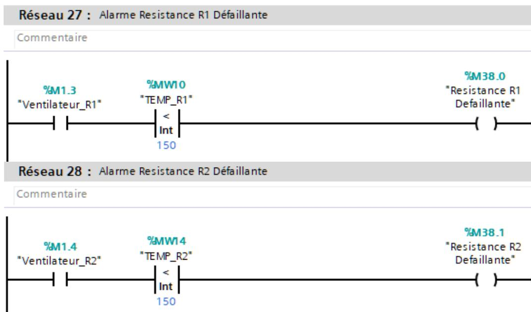
Figure III. 75 : Simulation de défaillance pour la résistance
