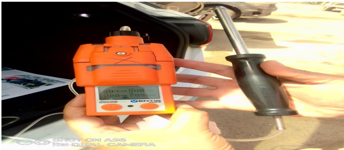
Figure III.25 :un explosimètre pour détecter les gaz (photo personnelle, 2022)
