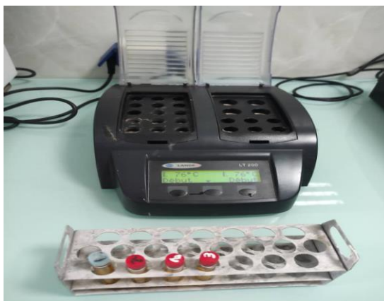
Figure 2. 22 : Cuves avant la mise au digesteur thermostat LT 200 à 148^\circ C pd 120min.
