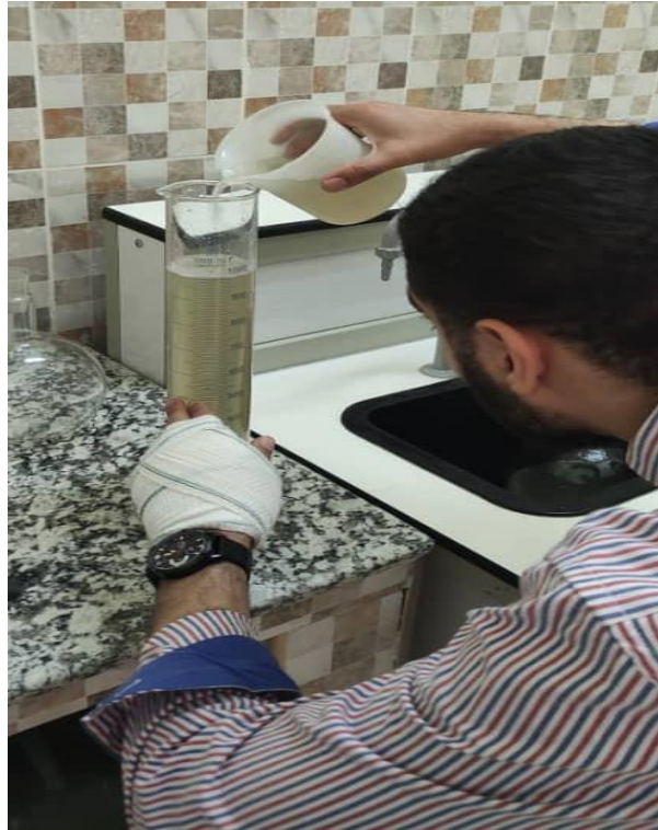
Figure 4. 4 : Remplissage de l'eau usée brute
