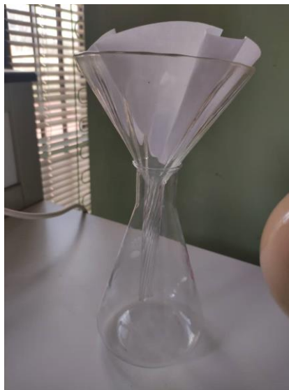
Figure 4. 9 : Exemple de préparation des filtres
