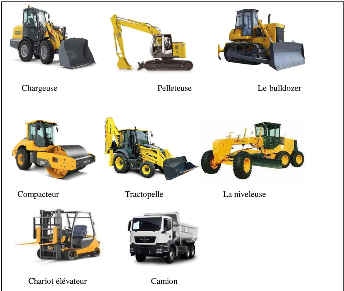
**Figure 28 : Différent engins utilisés dans les chantiers BTP**
