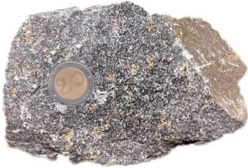
Photo. 6: Éch (S1) aspect macroscopique de calcaire gris compacte légèrement ferrugineux.
