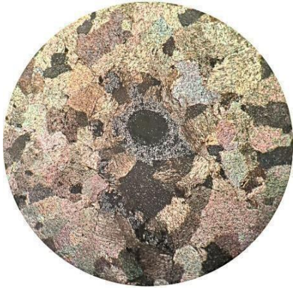
Photo.16 : Ech(S1) calcaire a cristaux de calcite de texture hétérogranulaire LP, G : X5.
