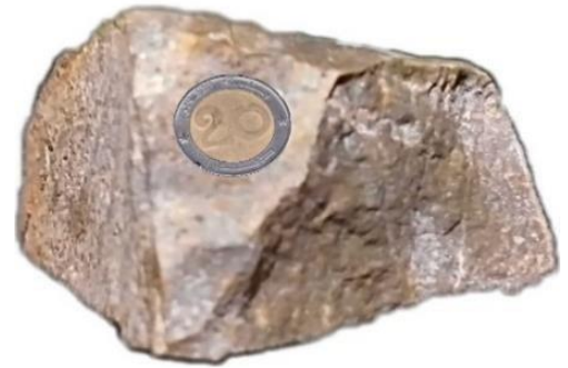
Photo.7: Éch (S1.1) aspect macroscopique de calcaire gris clair compacte légèrement ferrugineux.
