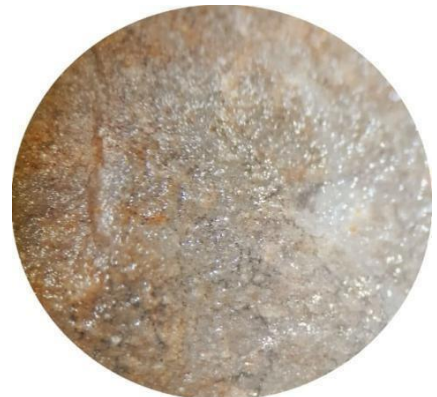
Photo.15 : Écha (S2) aspect microscopique calcaire a microfractures remplies par de la calcite. LP, G : X5.
