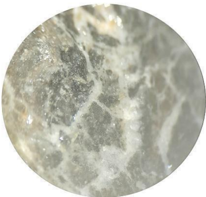
Photo.14 : Éch(M3) aspect microscopique marnes indurées verdâtre à grains de quartz LP, G : X5.
