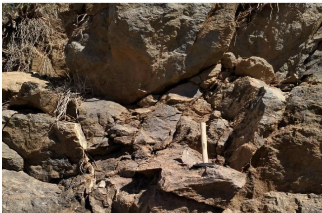
Photo.3 : Calcaire compacte de couleur bleuâtre a grisâtre.
