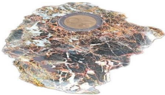
Photo.8 : Éch(S1.2) aspect macroscopique calcaire gris de texture hétérogène a veinules remplie de calcite et d'oxyde de fer.
