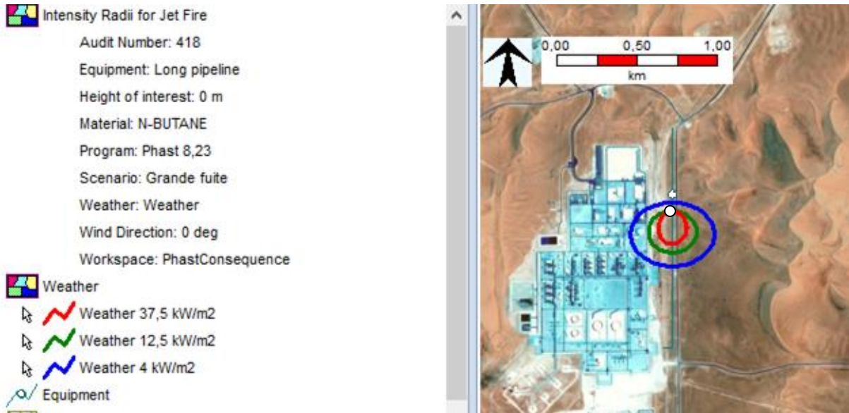
Figure 96 : Les effets de jet de feu (Grande fuite).
