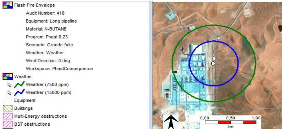
Figure 80 : Les zones atteintes par le feu de flash (Grande fuite).
