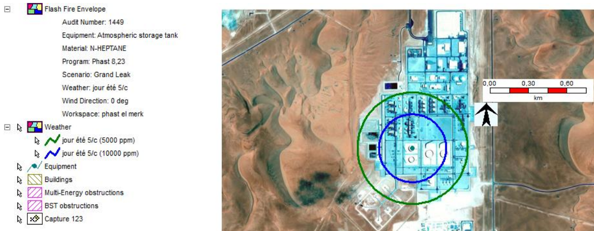
Figure 37 :Les zones atteintes par le feu de flash (Grande fuite).
