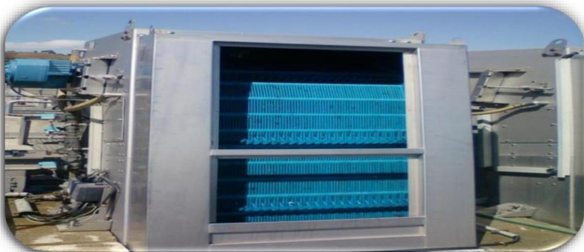
*Figure III.13 - Le dégrilleur fin*
