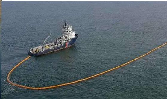
**Figure 59 Mise en place d'un barrage anti-pollution autour d'un navire citerne à quai**
