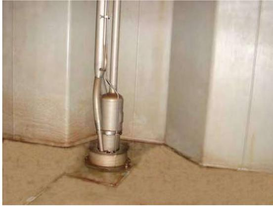
**Figure 53** Pompe immergée dans une citerne de chimiquier (entraînement hydraulique)
