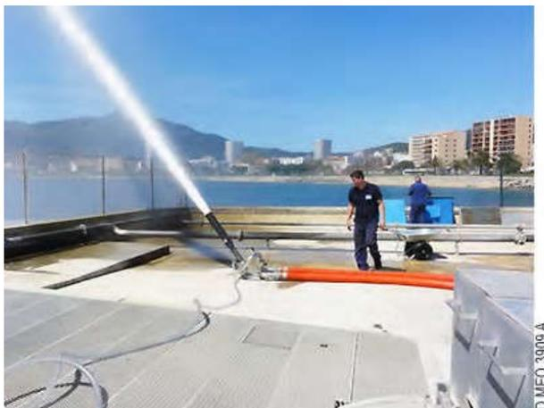
*Figure 45 Essai d'un canon mobile sur quai*
