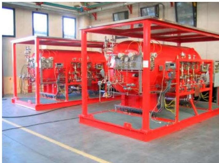
*Figure 51 dispositifs d'étouffement au CO<sub>2</sub> prêts à être installés sur un navire citerne*
