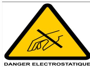
*Figure II.8 : signalisation d'électrostatique*
