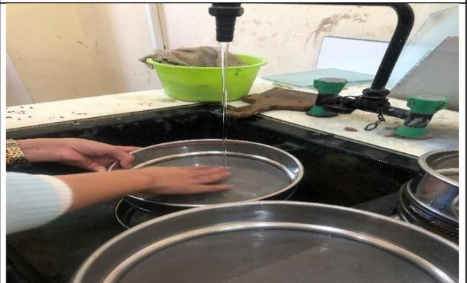
**Fig.10 : Procéder au lavage des échantillons à travers une colonne de tamis comportant les mailles suivantes : 250µm 100µm80 µm**
