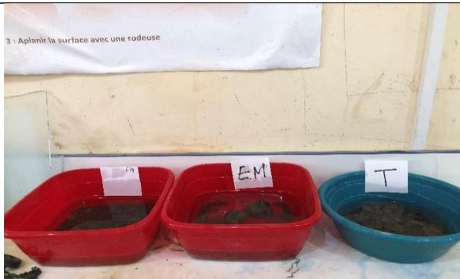
**Fig.9 : Mélanger les échantillons avec de l'eau, agiter et morceler à la main ou au mortier. Laisser reposer de quelques heures à quelques jours**
