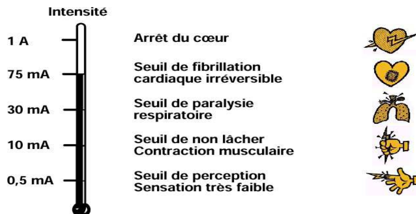
Figure I.43: Seuils de danger du courant électrique alternatif.
