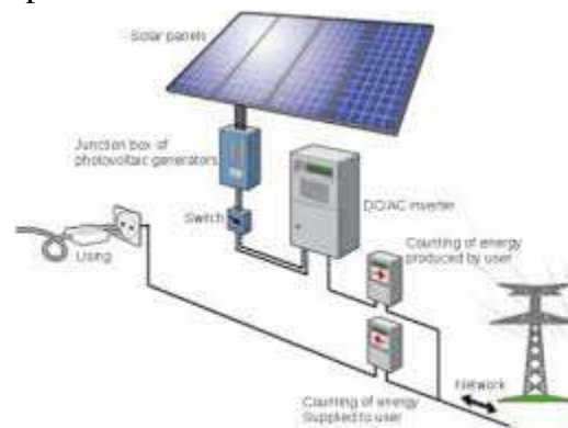
Figure II.15 : Schéma de principe d'un générateur photovoltaïque.
