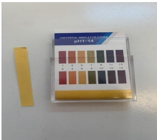
Figure IV.9 : Papiers pH utilisé pour la mesure de la valeur du pH des échantillons de rejets liquides.
