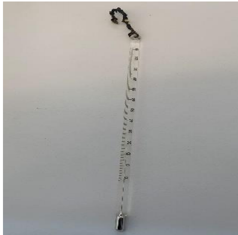
Figure IV.8 : Thermomètre utilisé pour la mesure de la température des échantillons de rejets liquides
