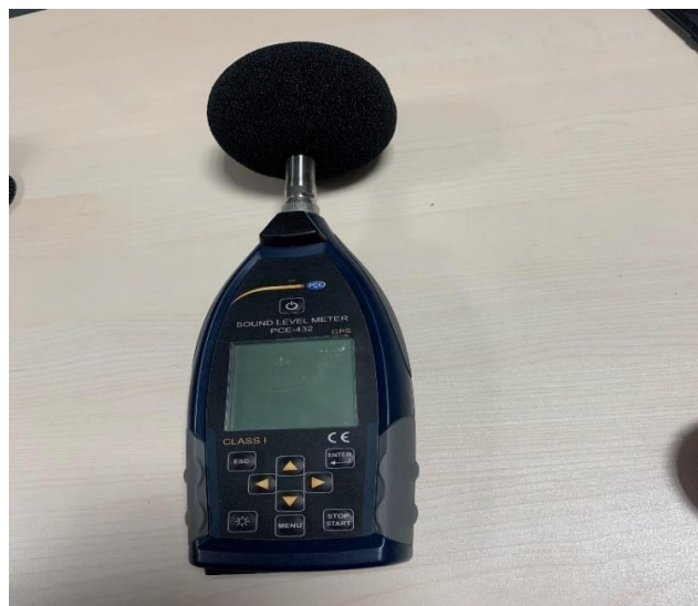
Figure IV.13 : Sonomètre disponible au sein de la direction du centre de production.
