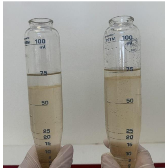
Figure IV.11 : Réactif utilisé et séparation des huiles contenues dans les échantillons.
