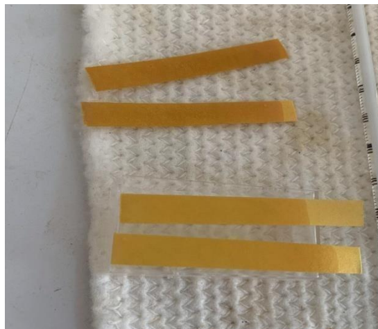
Figure IV.9 : Papiers pH utilisé pour la mesure de la valeur du pH des échantillons de rejets liquides.
