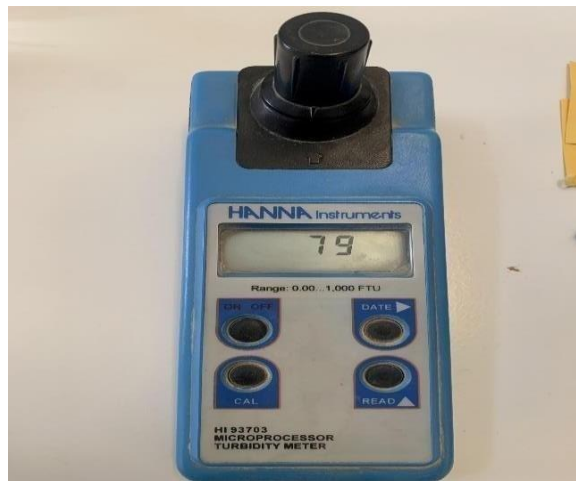
Figure IV.10 : Turbidimètre utilisé pour la mesure de MES des échantillons de rejets liquides.
