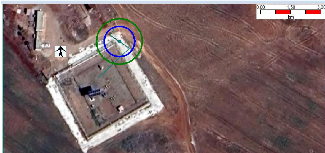
Figure 30: Flash fire suite à moyenne brèche
