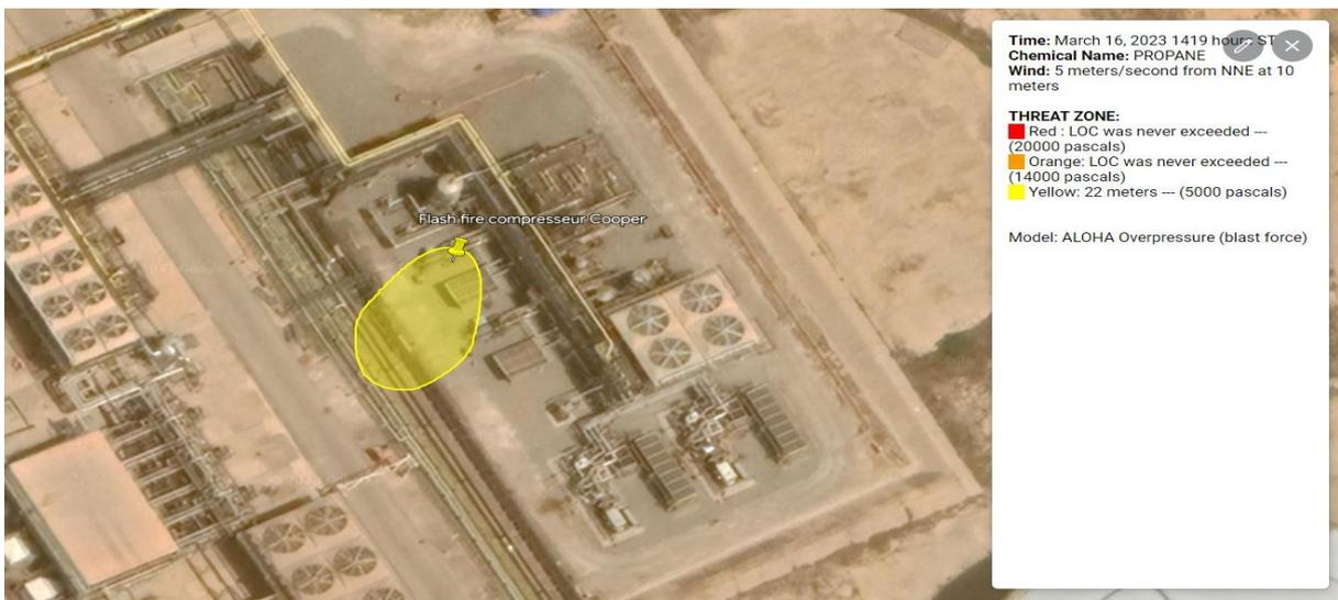
**Figure IV - 38 :** Flash fire de compresseur Cooper
