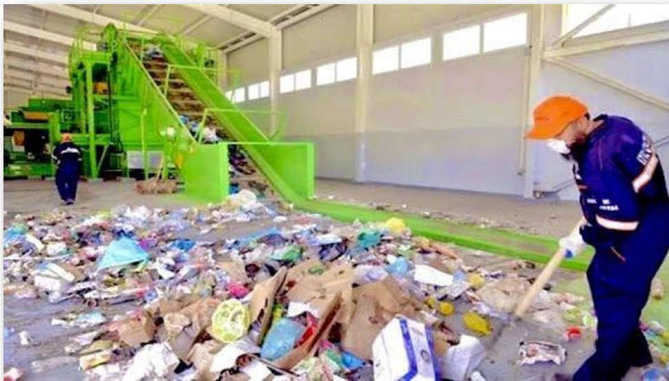
Figure IV.2 : Le tri manuel au niveau de le hangar de tri du CET.
