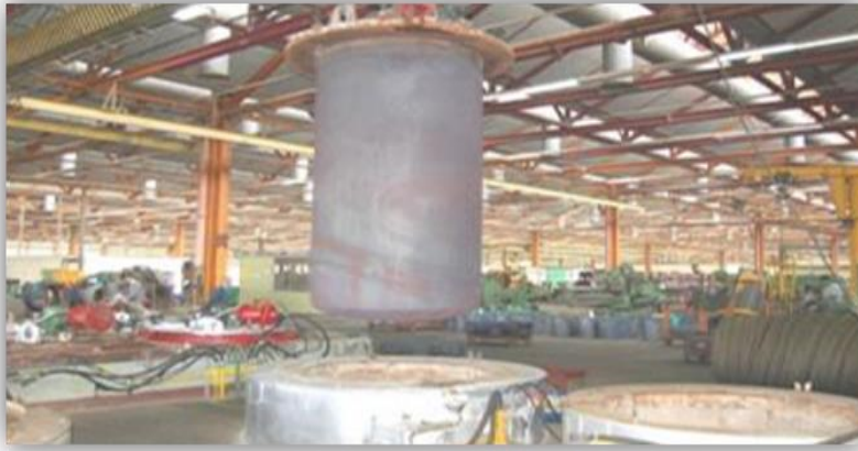
Figure III.3. Le recuit utilisé lors de l'élimination de l'écrouissage
