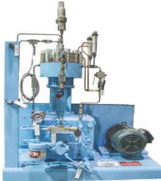
**Figure II.13 :** Le compresseur à membrane à un étage [23]
