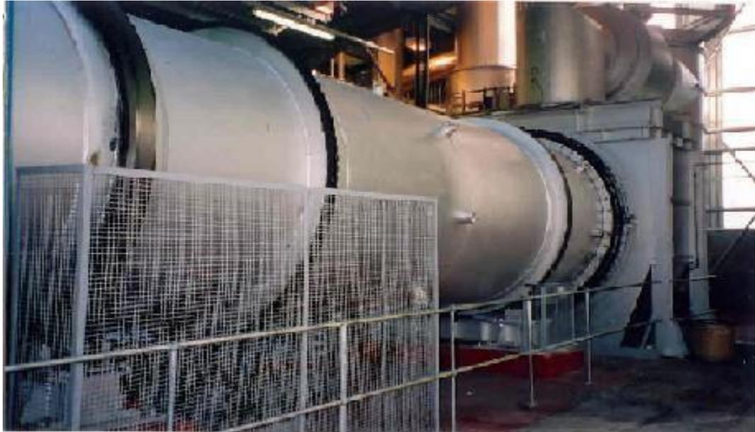
**Fig. 3.2 : Incinérateur à four rotatif [23].**
