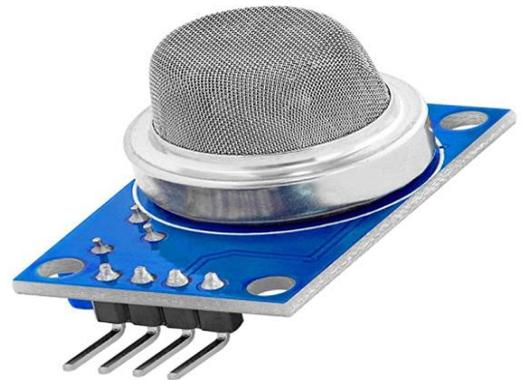
Figure 11. Capteur MQ135
