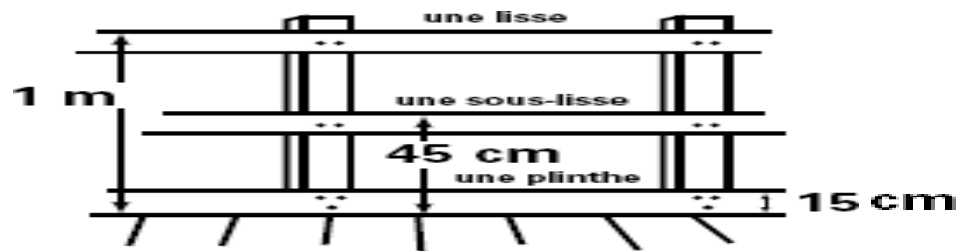
Figure 12. Les dimensions d'un gord corps [18]
