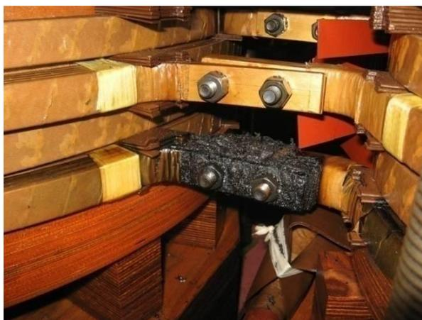
**Figure III- 12**Point chaud sur connexion boulonnée
