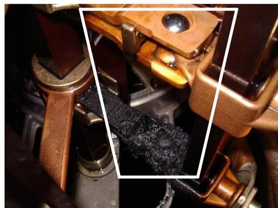
**Figure III- 7 Point chaud sur le sélecteur d'un régleur en charge**
