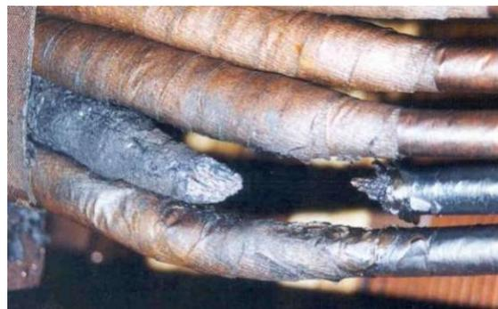
**Figure III- 8 Coupure suite à la fusion d'un conducteur**
