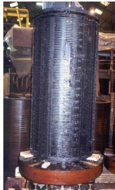
Figure III- 13 Echauffement excessif d'un enroulement
