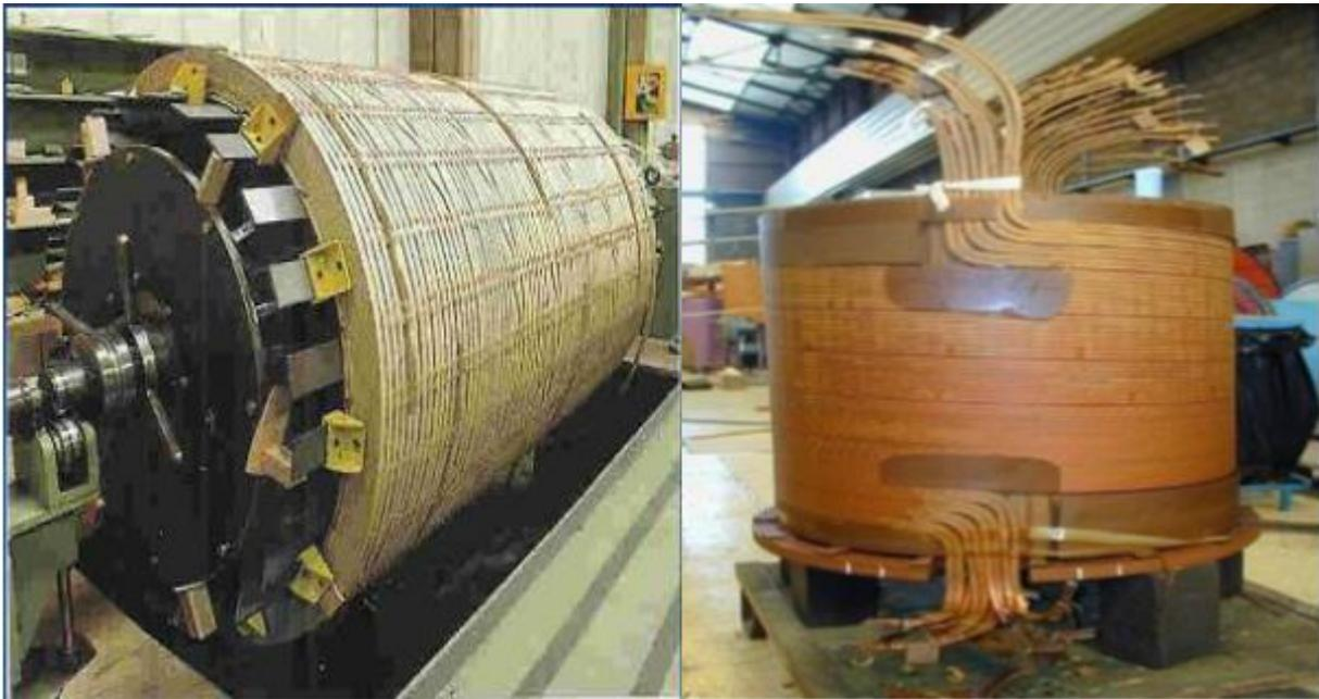
Figure I- 13 Enroulement d'un transformateur
