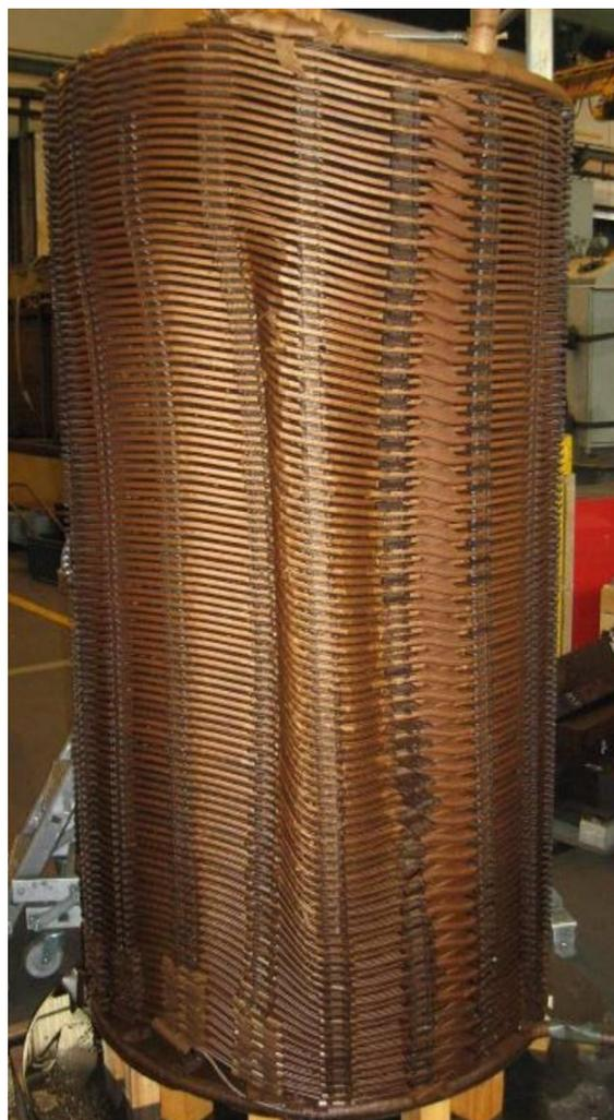
**Figure III- 9 Déformation mécanique d'un enroulement**
