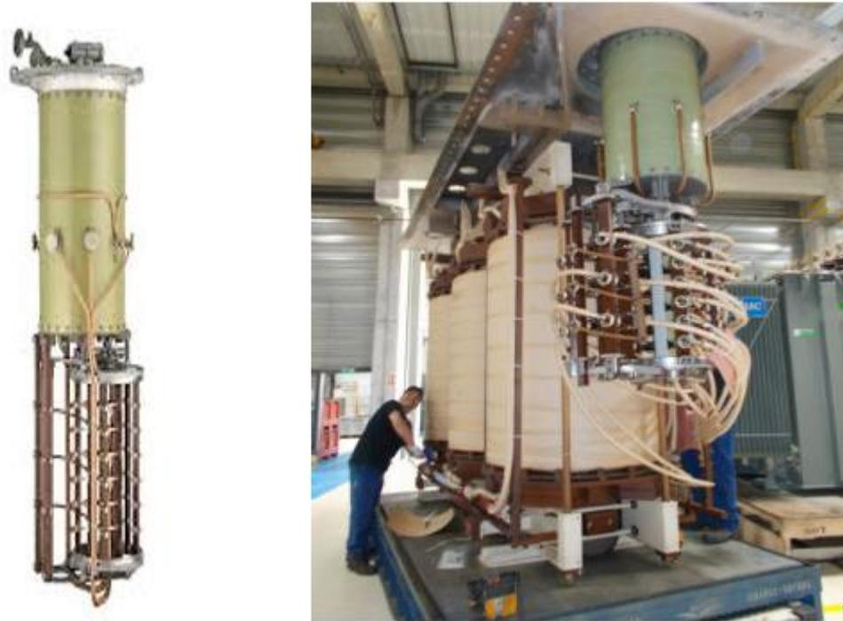
Figure I- 17 Changeur de prise en charge
