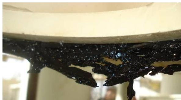
Figure III- 16 Joint de traversée écrasé
