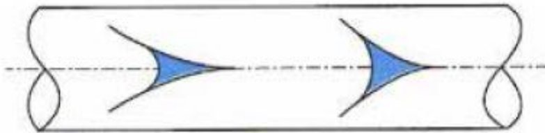
Figure (2.16) : Criques de surface, appelées pattes de corbeaux
