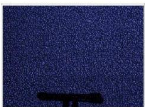
Figure III.16 : Exemple de motif infrarouge projeté par la Kinect. [27]
