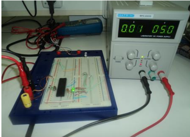
Figure 3.46 : Test réel clignotement d'une LED.
