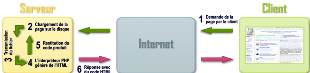
**Figure III-25.** Schéma de l'exécution du code PHP <sup>[15]</sup>
