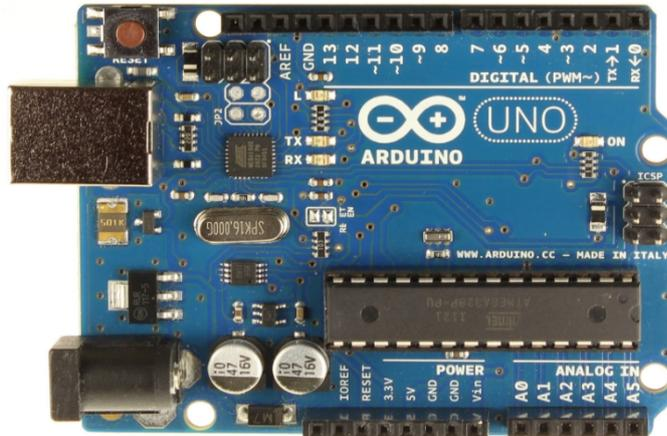
**Figure III-16.** Carte Arduino "Uno" utilisée pour la réalisation
