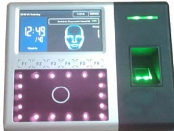
**Figure I-15.** Pointeuse biométrique
