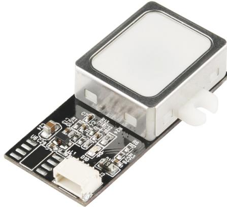
Figure III-11. Le capteur d'empreinte GT511C3
