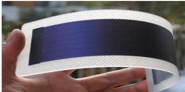
Figure I.17 : Une cellule amorphe souple.
