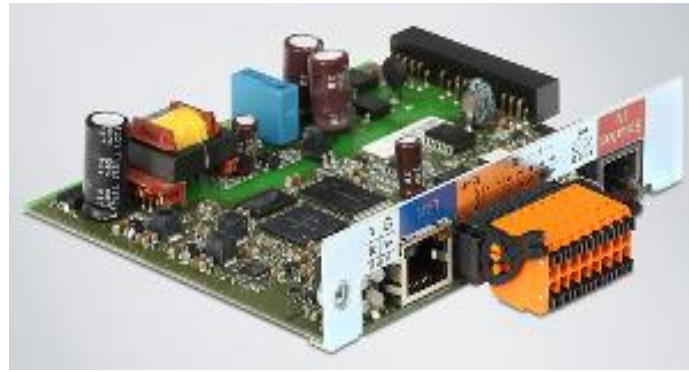
Figure III.2 : Carte interne d'un datalogger, copyright FRONIUS.
