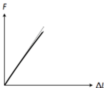
Figure II.22 : Courbe effort-allongement mesurée sur un [0,90] s .
