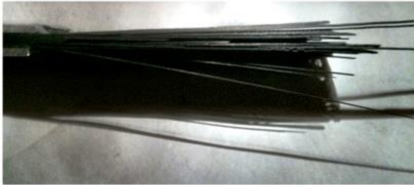
Figure II.20 : Eprouvette unidirectionnelle après rupture : on observe de nombreuses fibres rompues.
