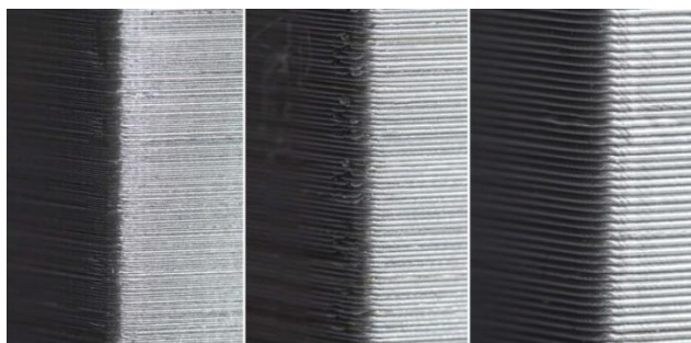
Figure.III. 17:Un examen plus approfondi de l'impact de la hauteur de couche sur la finition de surface.
