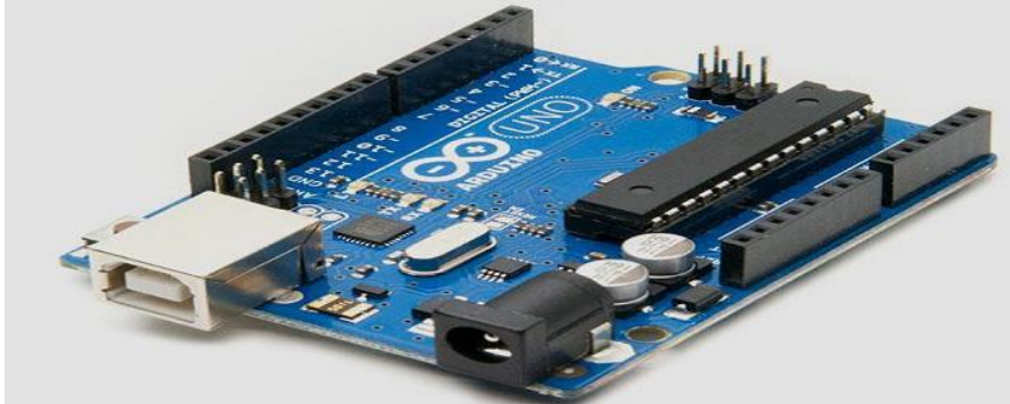
Figure II.12: La carte Arduino UNO
