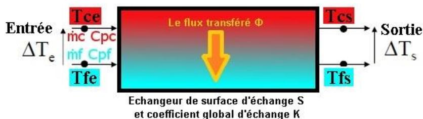
Figure I.2 : Schéma caractéristique d'un échangeur de chaleur
