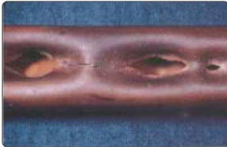
Figure I.11 : Tube endommagé par effet de marteau par la vapeur d'eau [9]
