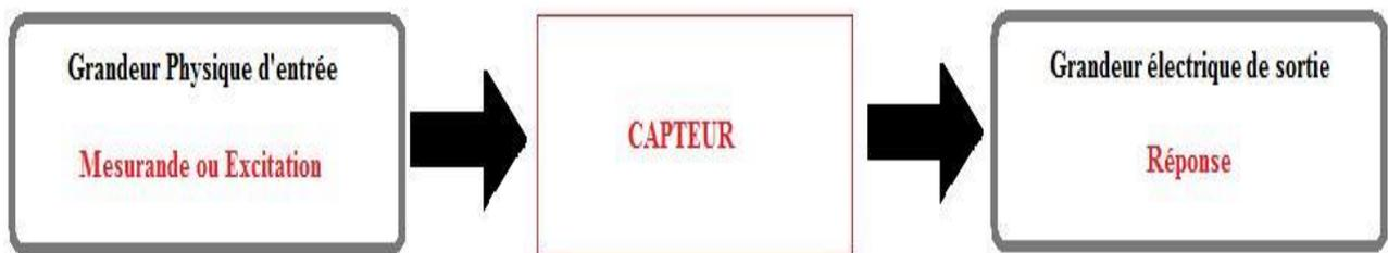
Figure II.2 : Schéma de principe de rôle de capteur.
