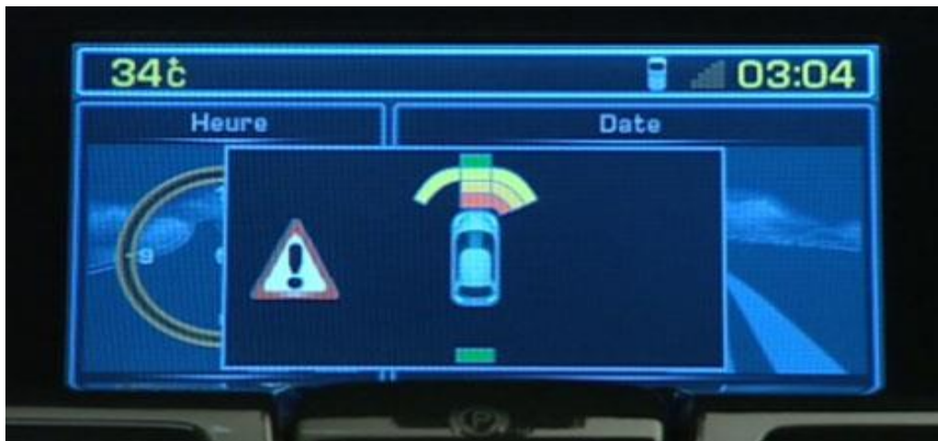
Figure II.21 : Affichage graphique d'aide au stationnement sur écran LCD.
