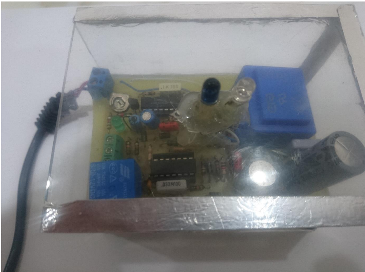
Figure IV.12. Allure finale du capteur (circuit+boîtier+secteur d'alimentation).
