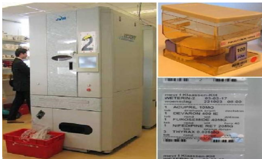
Figure 1.3. Automate de dispensation de formes orales sèches.
