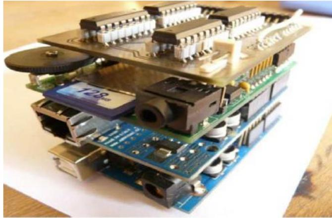
**Figure I.7.** Une carte Arduino équipée de plusieurs cartes d'extension.
