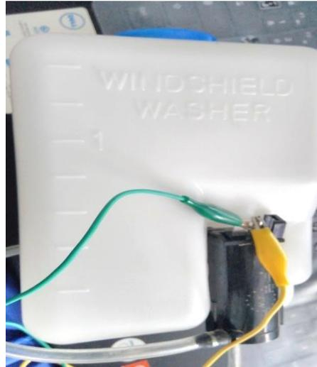
**Figure 0.5.** Pompe à eau et la cuve de source d'eau.
