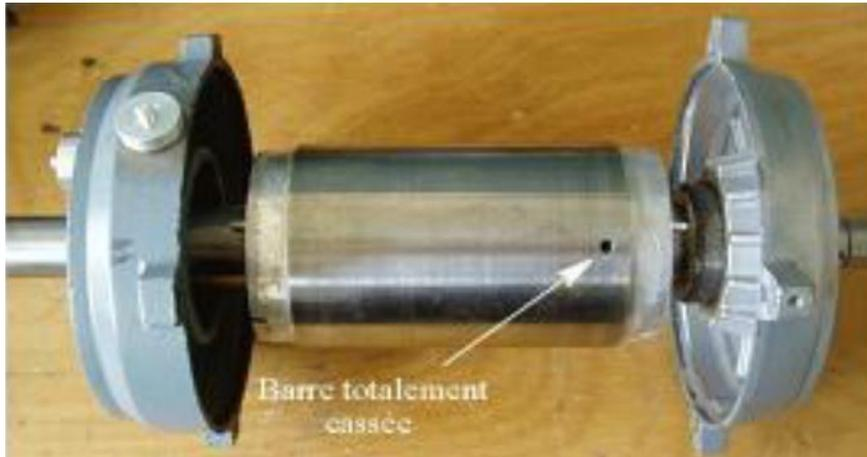
Figure I.7 : Photo d'une barre cassée [9].
