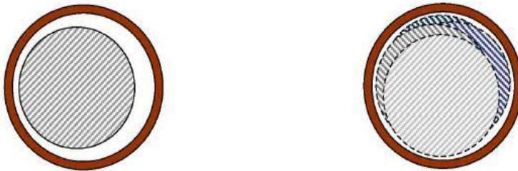
Figure I.5 : Modélisation schématique de l'excentricité statique et dynamique.
