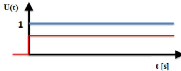
Figure III.12 : Réponse indicielle du régulateur PD [ETI14].
