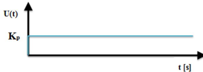
Figure III.4 : Réponse indicielle du régulateur P [ETI14].
