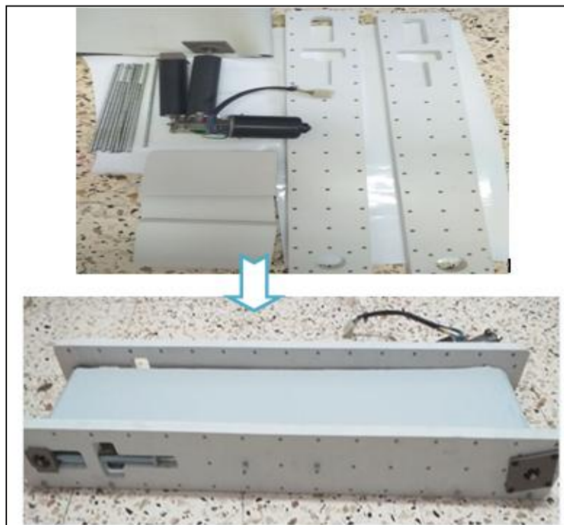
Figure IV.7.Photo réelle de convoyeur fabriqué en PVC avant et après le montage
