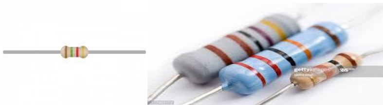
Figure1.2 : Exemples de résistances au carbone.
