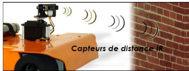
Figure 3.5: Capteur infrarouge monté sur une plate-forme robotique mobile (les capteurs infrarouges peuvent être utilisés pour éviter les obstacles, suivre les lignes et établir des cartes);[19]
