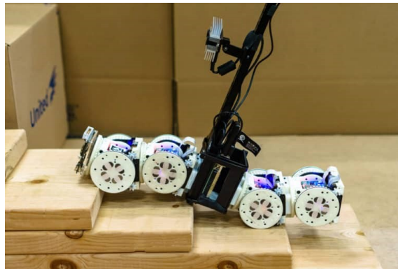
Figure 1.3: Robot modulaire à changement de forme(auto reconfigurable) ; https://rb.gy/scv8d4
