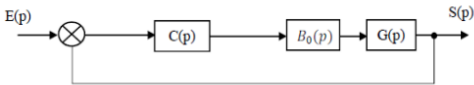
Figure V.2 : Modèle à temps continu de l'asservissement.
