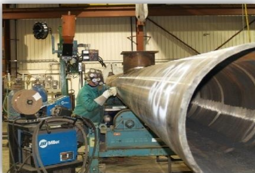
Figure (I-8) : Soudage manuel et automatique des tubes [9].
