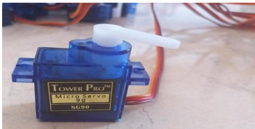
Figure IV.3. Photo réelle d'un servomoteur sg90.
